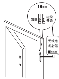
无线磁控安装
